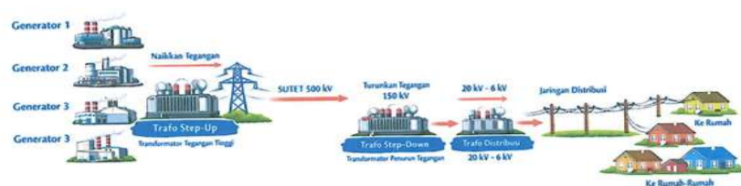
Diagram 2: Hierarki Pembangkitan dan Distribusi Tenaga Listrik
